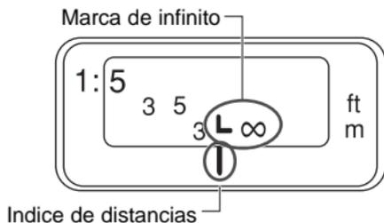
Para compensar el desplazamiento del punto de enfoque infinito que ocurre debido a cambios de temperatura.
