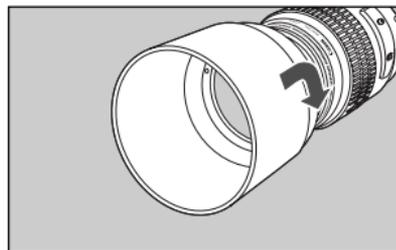
Instale y alinee el parasol con la montura del parasol en la parte delantera del objetivo, y gire el parasol en la dirección mostrada por la flecha para asegurarlo.
