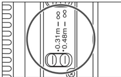
Se puede cambiar la escala de distancias de enfoque entre 0,31 m e infinito o 0,48 m e infinito. Un ajuste apropiado de la escala de distancias de enfoque permite reducir el tiempo de autoenfoco en la práctica.
