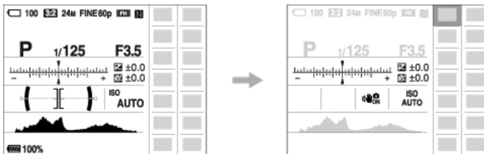
4. Seleccione la función deseada pulsando el lado superior/inferior/izquierdo/derecho de la rueda de control.
