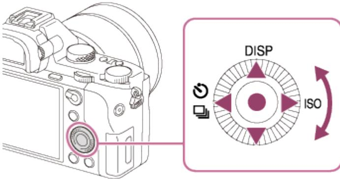
Puede seleccionar elementos de ajuste girando o pulsando el lado superior/inferior/derecho/izquierdo de la rueda de control. Su selección quedará determinada cuando pulse ● del centro de la rueda de control.
