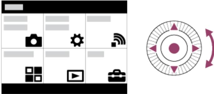
3. Seleccione el elemento de ajuste deseado pulsando el lado superior/inferior/izquierdo/derecho de la rueda de control o girando la rueda de control, y después pulse ● del centro de la rueda de control.
